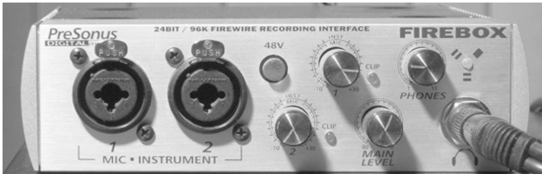
Hình 4.13: Đầu nối XLR kết hợp Neutrik này cũng chấp nhận jack 1/4inch, khiến nó thành ra lý tưởng cho thiết bị nhỏ như card âm thanh như PreSonus này có rất ít chỗ trống trên bảng điều khiển phía trước.
