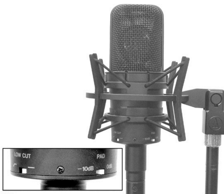
Hình 5.3: Micro Audio-Technica AT4033 này có hai switch, một bộ đệm (pad) 10dB và một cho bộ lọc low-cut.
