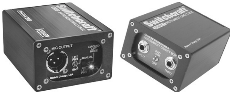
Hình 6.9: Hộp DI thụ động Switchcraft SC800 và SC900 này chứa biến thể Jensen chất lượng cao, chuyển đổi nguồn có trở kháng cao thành output có trở kháng thấp phù hợp với micro preamp. Những model này bao gồm jack cắm trong trường hợp bạn muốn gửi nhạc cụ đến keyboard hay ampli bass cùng lúc.
