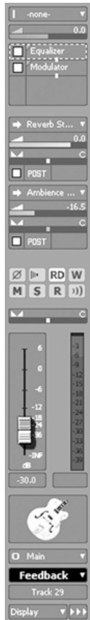
Hình 7.5: Hiện thị Track Clip như dạng sóng và đây là chỗ bạn thêm envelope và nút (node) để điều chỉnh âm lượng, pan hay bất kỳ tham số nào của plug-in đã insert. Đường kẻ đại diện cho envelope, vòng tròn nhỏ là nút.
