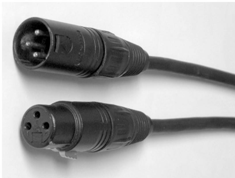
Hình 4.12: Thường sử dụng jack nối XLR cho cả mức độ tín hiệu micro lẫn line và hầu hết có ba pin, cộng, trừ và mass.
