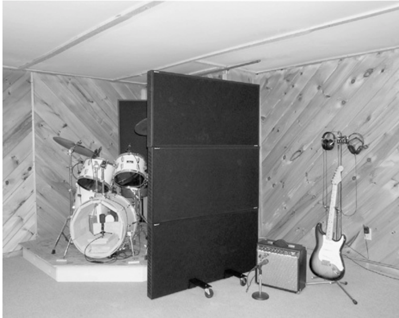
Hình 6.11: Gobo có bánh xe này đủ lớn để chặn phần lớn âm thanh từ toàn bộ bộ trống.
