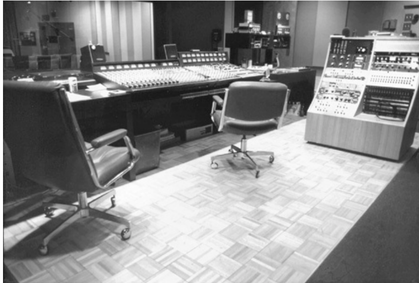
Hình 5.5: Tác giả đã xây dựng console 16 channel này vào thập niên 1970 cho phòng thu âm chuyên nghiệp do ông thiết kế và điều hành ở East Norwalk, Connecticut. Bên cạnh console này, Ethan cũng thiết kế và chế tạo nhiều thiết bị bên ngoài mà bạn thấy trong rack.
