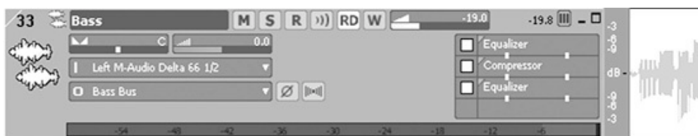
Hình 7.3: Phần Track Controls cho phép bạn điều chỉnh mọi thuộc tính của track, bao gồm chỉ định bus và hiệu ứng plug-in.
